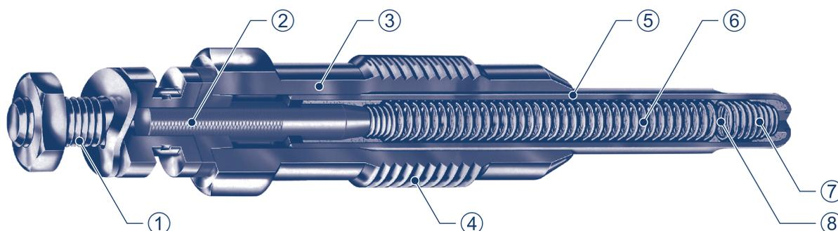
1. **Terminale.** Funge da connettore con la centralina elettrica. Si distinguono principalmente in due tipologie: terminale filettato o con connettore a pin.
