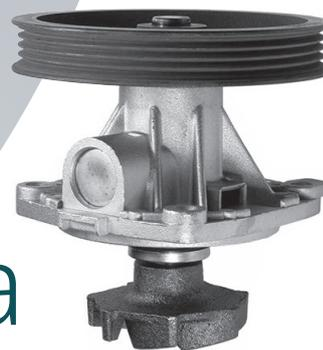
Uma bomba de água a funcionar correctamente garante que o líquido refrigerador flua correctamente pelo circuito de refrigeração.
